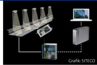
Modernes Lichtmanagement braucht elektronische Betriebsgeräte: Komponenten wie Vorschaltgeräte oder Sensoren übernehmen das Steuern und Regeln der Beleuchtung und sorgen für bedarfsgerechtes Licht. Mit der Steuerung der Ein- und Ausschaltzeitpunkte der Beleuchtungsanlage wird eine dem aktuellen Bedarf angepasste Nutzung gewährleistet.
