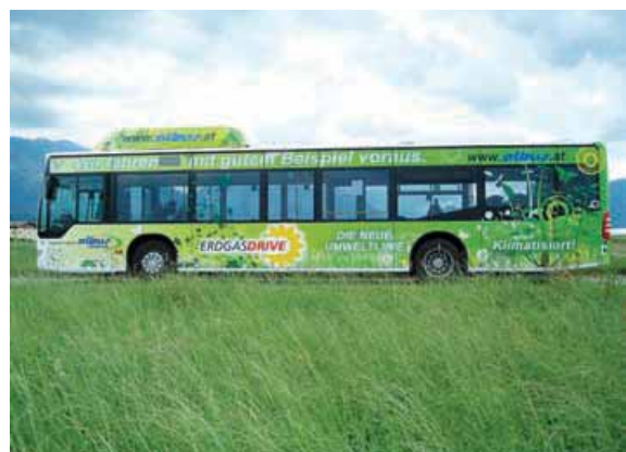
Albus Salzburg: Umstellung von 12 Solo- und 7 Gelenkbussen auf Erdgas-/Biogasantrieb und Errichtung einer Gastankstelle. Einsparung von 539 Tonnen CO 2 pro Jahr. Foto: Albus Salzburg
