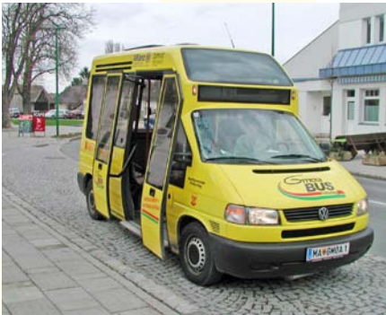
Ferngesteuerte Türen und ein niedriger Einstieg erleichtern mobilitätseingeschränkten Personen das Ein- und Aussteigen
