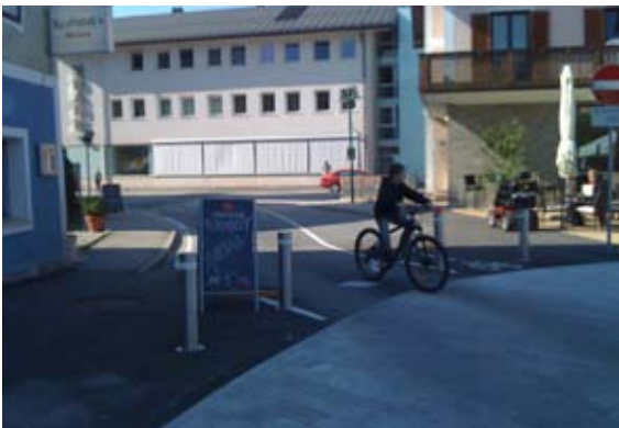
44 Poller verhindern die Einfahrt von Kfz in die Fußgängerbereiche der Koexistenzzone.
