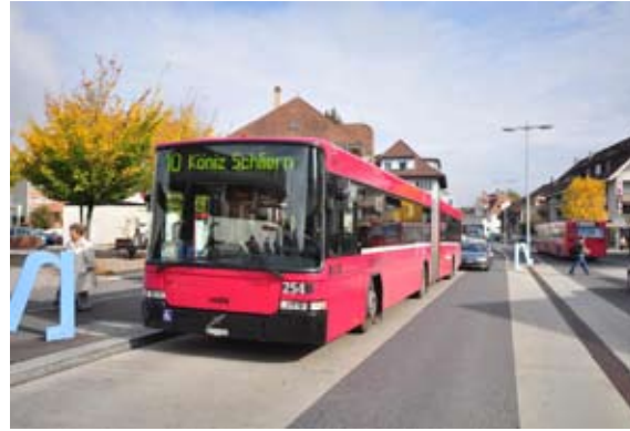
98 Fahrbahnhaltestelle der Buslinie
