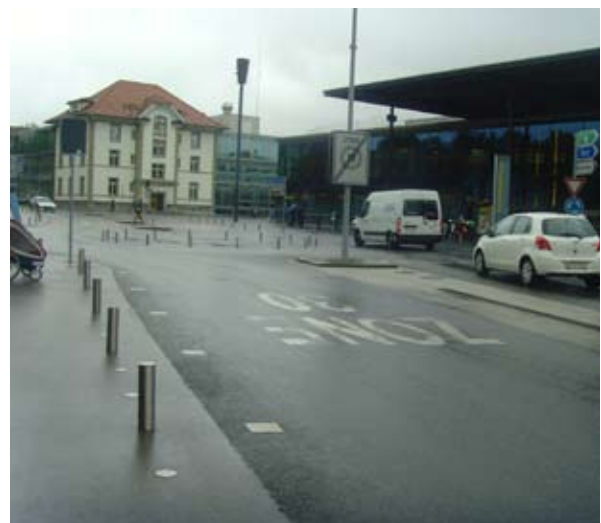
129 Poller definieren die Grenze zu dem Bereich, der nicht von Autos befahren werden soll.
